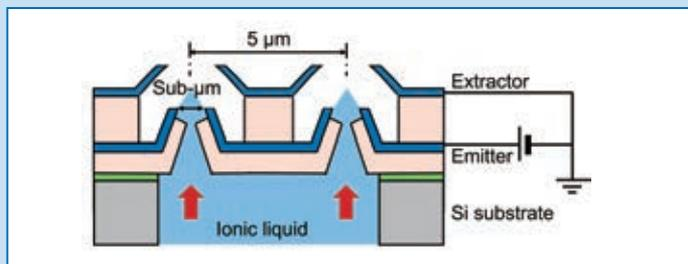
図2 高密度化イオン源の構造
