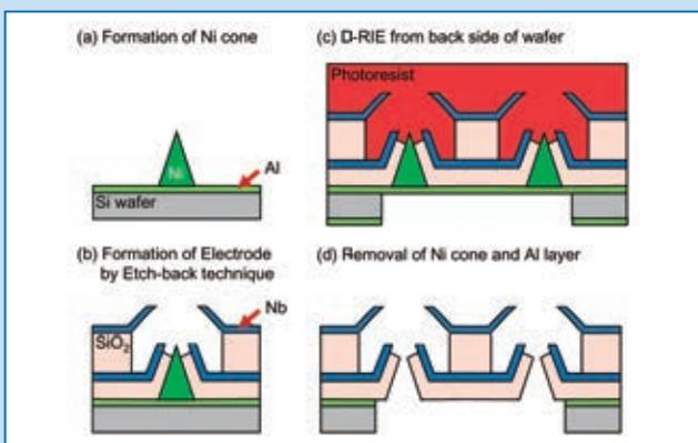
図3 電極の作成プロセス
