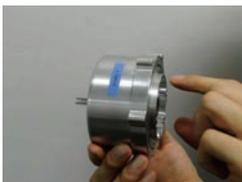
減速比1/97の開発ギヤのバックドライブの様子
