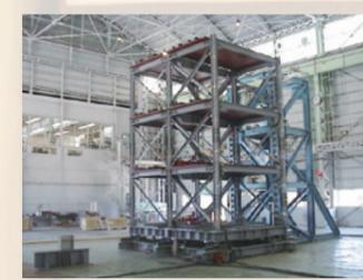
実物大構造物の振動制御実験
