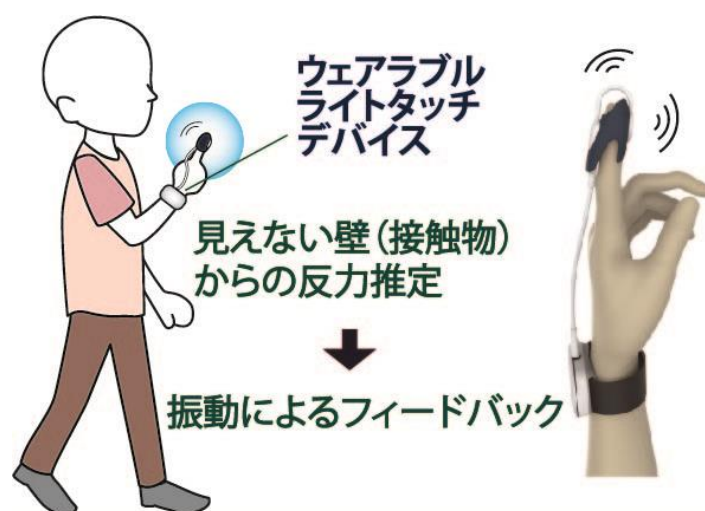
図1 提案手法：仮想壁に被験者が接触した際に振動刺激として仮想反力がフィードバックされる。
