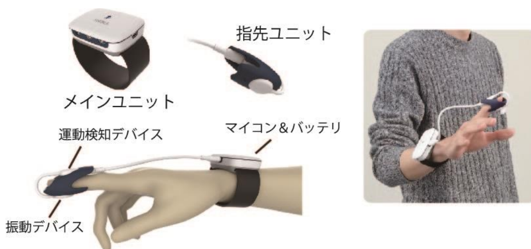
図2 開発した小型転倒予防装置：指先に装着する3軸加速度センサと小型の振動子部、手首に装着するマイコンとバッテリーから構成される。
