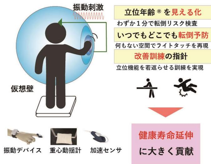
図4 立位機能検査 StA<sup>2</sup>BLE の製品構成、動作説明
