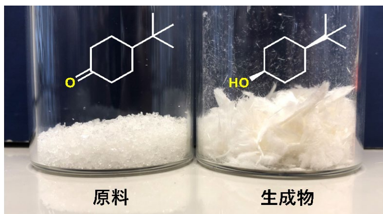
図 3. 本反応に用いた原料と実際に合成した環状アルコール（シス体選択性 98%）
