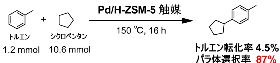
図 6. Pd/H-ZSM-5 によるトルエンとシクロペンタンの反応
