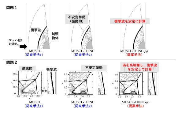
図:従来手法と提案手法によるベンチマークテスト(計算手法の性能検証のための問題)の計算結果を示しています。問題1は、超音速流れに置かれた鈍頭物体前方に発生する衝撃波を定常計算する問題です。提案手法は衝撃波の発生に対して安定した解を示しました。問題2は、衝撃波が壁で反射する現象を非定常計算する問題です。提案手法は2つの従来手法と比較し、衝撃波を安定して計算し、かつ渦を高解像することに成功しています。このように提案手法は、複数の問題に対して高解像・安定に計算することが示されました。
