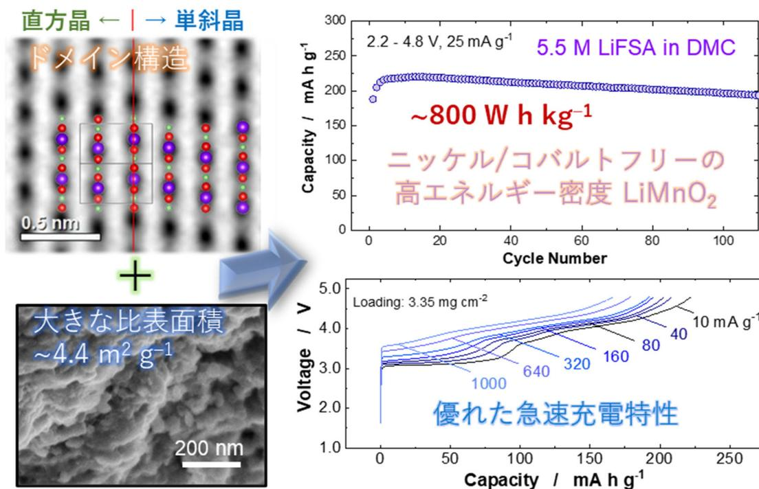
横浜国立大学・名古屋工業大学・島根大学の研究グループにおけるナノ構造を高度に制御したリチウムマンガン酸化物 ( $\text{LiMnO}_2$ ) に関する研究成果の概要図
